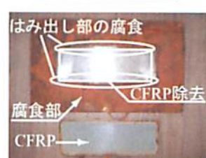
(d) 絶縁, CPF 試験体
